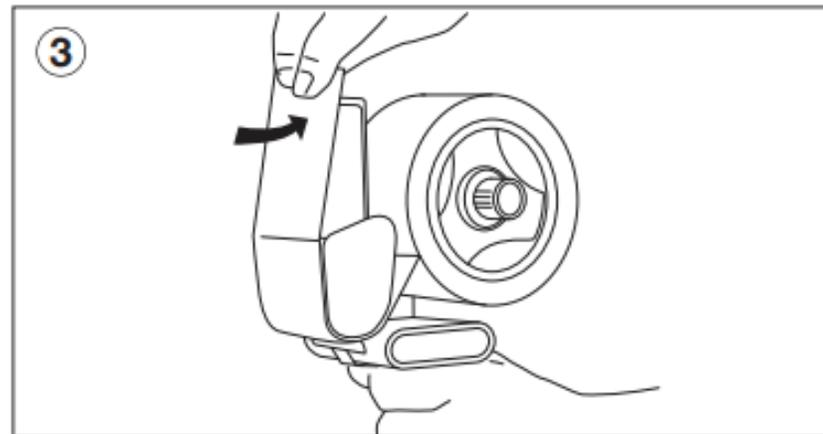
Regolare la tensione sull'erogatore (al centro della ruota grande dell'erogatore) per uno svolgimento fluido e confortevole. **ATTENZIONE:** la lama da taglio è affilata, prestare attenzione durante il caricamento e la regolazione della tensione, utilizzare con attenzione.
