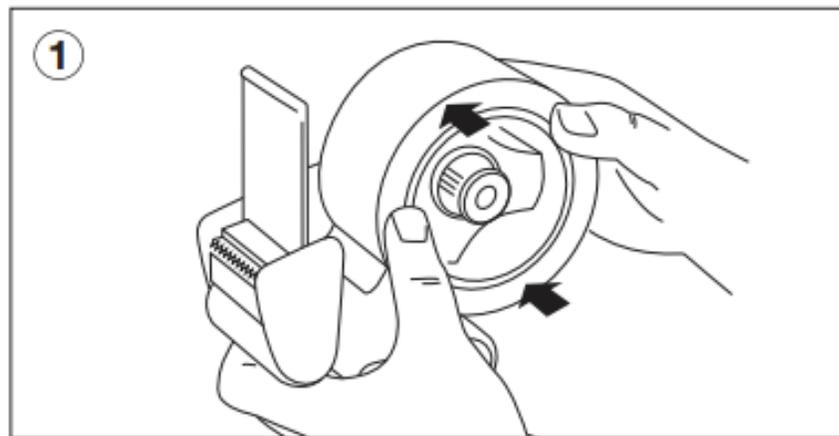
Inserire il rotolo di nastro adesivo sulla ruota grande del dispenser (vedi in alto a destra).
