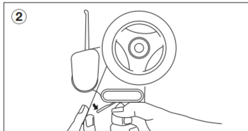
Tirare l'estremità anteriore del rotolo di nastro attraverso la fessura tra il rullo dell'erogatore e la guida di metallo.
