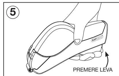
5 Premere il grilletto per avviare il meccanismo e caricare il nastro nell'apertura anteriore.
