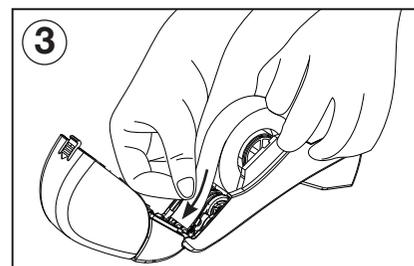
3 Distendere il nastro di circa 30-40 mm in modo che l'estremità raggiunga la fine del dispositivo, permettendo al nastro rimanente di appoggiarsi facilmente sugli elastici.
