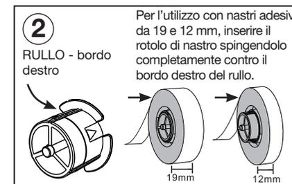
2 Installare il nastro adesivo della giusta misura sul rullo e montare nuovamente quest'ultimo sull'apposito supporto.
